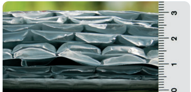
Der Querschnitt durch die geöffnete redstone Wärme-dämmfolie WDF zeigt die 13 Schichten des Materials.
