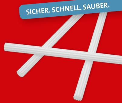
Das Gemisch durchdringt das Mauerwerk über Osmose oder Diffusion und bildet somit eine wirksame Barriere gegen aufsteigendes Wasser. Dazu einfach mit einem 12 mm Bohraufsatz Bohrlöcher in die Mörtelfuge bohren, Verpackung öffnen, Sticks einführen und Bohrloch mit einem Mörtelpfropfen (z.B. mit Secco Due, Secco Sperrputz oder Secco Waterproof) verschließen.
