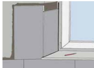
▲ Clima Paramur Laibungsplatte Die Clima Paramur Laibungsplatte ist mit ihren Abmessungen von 250 x 500 x 15 mm für die effiziente und effektive Sanierung von Laibungen konfektioniert.
