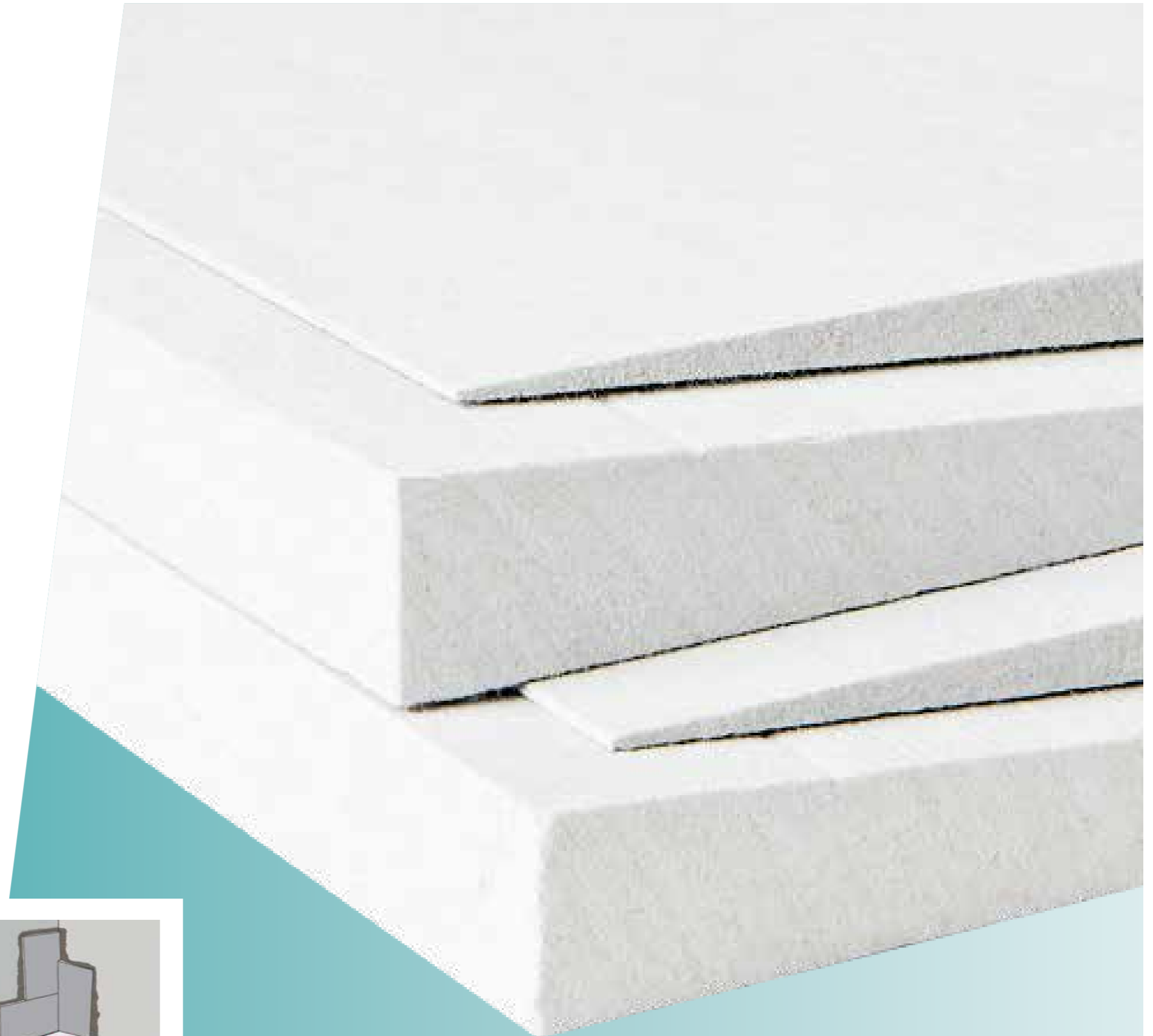
▲ Clima Paramur Keilplatte Die Clima Paramur Keilplatte entspricht hinsichtlich ihrer Struktur und ihres Aufbaus der Clima Paramur. Sie verläuft von 28 mm Plattendicke auf 5 mm in Richtung Innenraum.
