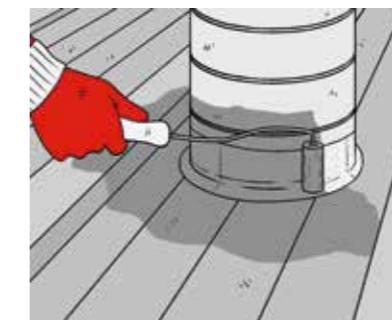
▲ 4. Sonderformen Auch runde Übergänge können einfach und schnell mit Redo Flüssigfolie abgedichtet werden.
