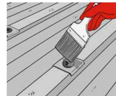
▲ 3. Punktueller Lösungen Besonders bei kleinteiligen Leckagen eignet sich die hochelastische und rissüberbrückende Redo Streichfolie.
