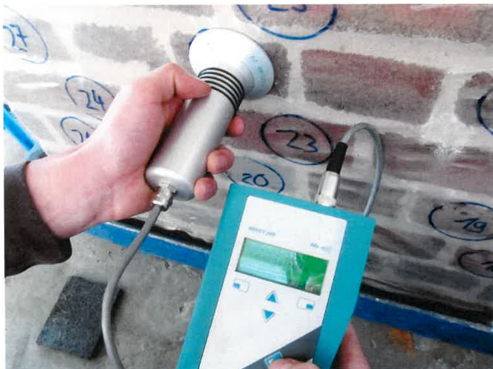
Bild 4 Messprinzip Feuchtemessungen mit Mikrowellenfeuchtemessgerät
